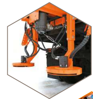
Заднее распределяющее устройство тарельчатого типа РАР-3.1
