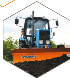
Конструкция позволяет работать с грунтом 1-ой категории
