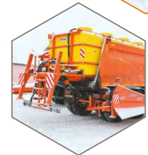
Емкость может устанавливаться на шасси или в кузов самосвала, а также на раму тракторного прицепа
