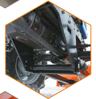
Надежная рама, удлиненные лонжероны, внутренние усилители
