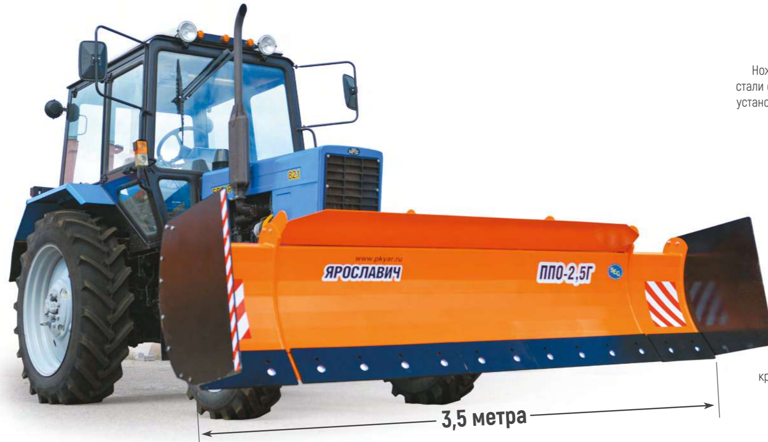
Конструкция позволяет работать с грунтом 1-ой категории
