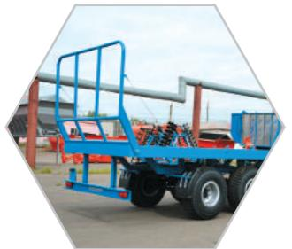
Рама и платформа изготовлены из легированной конструкционной стали
