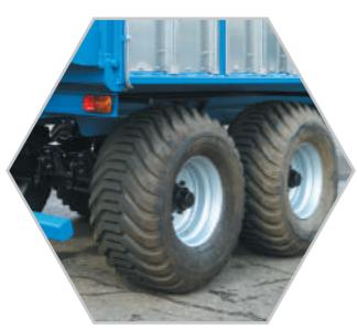
2-х-осная рессорная тележка итальянского производства с широкопрофильными шинами низкого давления
