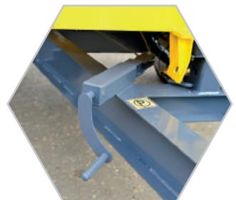
Стояночный тормоз и пневматическая рабочая тормозная система
