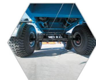
2-х-осная рессорная тележка итальянского производства с широкопрофильными шинами
