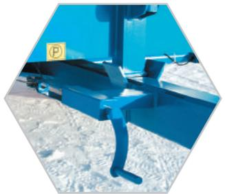
Стояночный тормоз и пневматическая рабочая тормозная система
