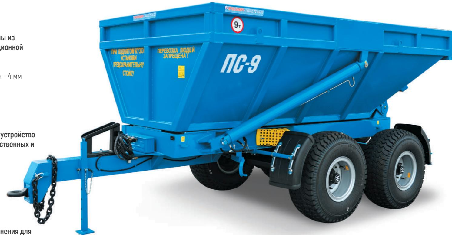
Цельнометаллический герметичный кузов позволяет перевозить полужидкие грузы
