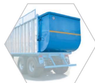
Полуприцеп самосвальный с донным транспортером ПСПД-15 в комплектации с разбрзывателем органических удобрений (навозоразбрзывателем) предназначен для поверхностного внесения в почву навоза, органических удобрений, компоста, отстоев или других однотипных грузов, кроме тяжелых плотных грузов (например, дефекатов и пр.); с задним штатным бортом используется для перевозки различных сельскохозяйственных грузов.
