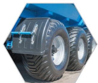
3-х-осная рессорная тележка итальянского производства с широкопрофильными шинами низкого давления и подрессоривающей задней осью
