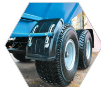
Полуприцеп ПС-9 предназначен для перевозки твердых, сыпучих и полужидких грузов (зерно, корнеплоды, зеленая масса, силос, сенаж, навоз, птичий помет, торф, песок, гравий, удобрения, опилки, снег и пр.) по всем видам дорог и в полевых условиях.
