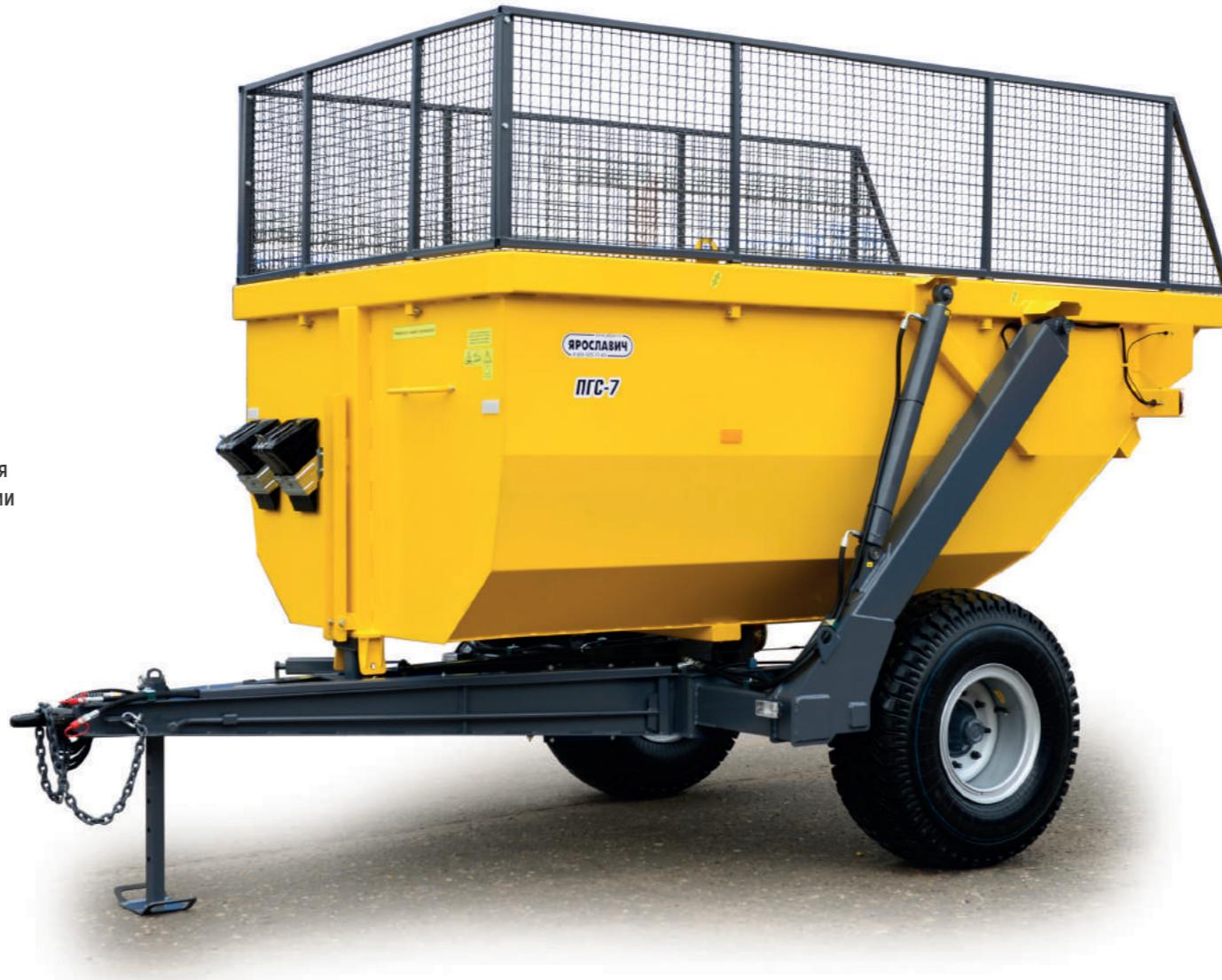
Полуприцеп ПГС-7 предназначен для транспортировки различных сельскохозяйственных грузов: зерновых, корнеплодов, твердых, полужидких и жидких органических удобрений, строительных материалов и других грузов по всем видам дорог, а также в полевых условиях. При использовании надставных бортов возможно перевозить сено, сенаж, силос.
