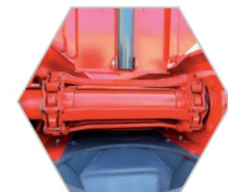
Полуприцепной универсальный распределитель материалов УРМ-10 предназначен для перевозки и поверхностного внесения в почву твердых минеральных удобрений, известковых материалов, доломитовой муки и других химических мелиорантов. Агрегатируется с тракторами не менее 3 тягового класса, оборудованных насосом НШ-50 (и выше) и раздельно-агрегатной гидросистемой.
