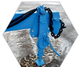
Регулируемая опора хранения для удобного зацепления за трактор
