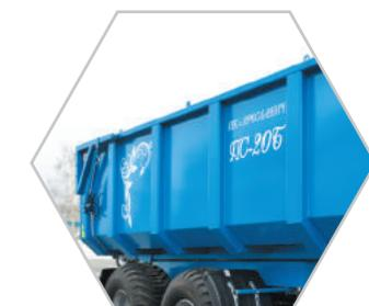
Окраска двухкомпонентной полиуретановой эмалью поверх коррозионностойкого грунта с последующей сушкой в специальной окрасочно-сушильной камере
