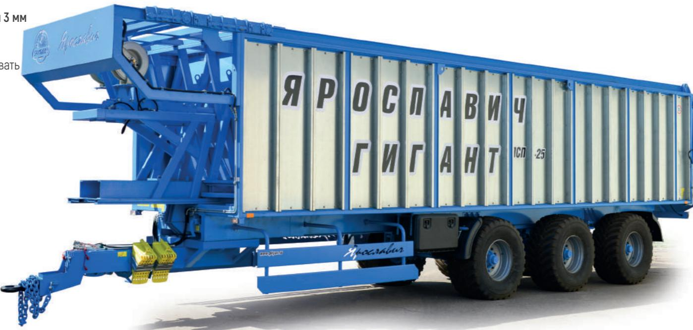
Полуприцеп ПСП-25 «Гигант» предназначен для перевозки различных сыпучих и твердых грузов (зерно, корнеплоды, зеленая масса, силос, сенаж, навоз, торф, удобрения, опилки, снег и пр.) по всем видам дорог и в полевых условиях.
