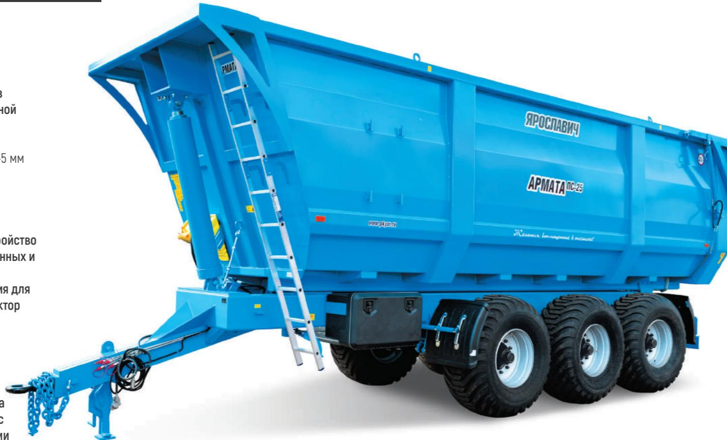
Полуприцеп ПС-25БМ «Армата» предназначен для перевозки сыпучих и твердых грузов (зерно, корнеплоды, зеленая масса, силос, сенаж, навоз, торф, песок, гравий, удобрения, опилки, снег и пр.) по всем видам дорог и в полевых условиях.
