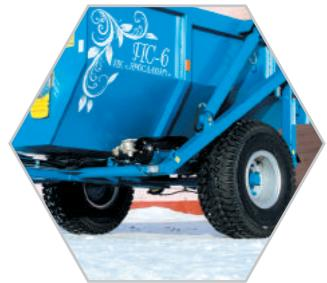
Полуприцеп ПС-6 предназначен для перевозки твердых, сыпучих и полужидких грузов (зерно, корнеплоды, зеленая масса, силос, сенаж, навоз, птичий помет, торф, песок, гравий, удобрения, опилки, снег и пр.) по всем видам дорог и в полевых условиях.
