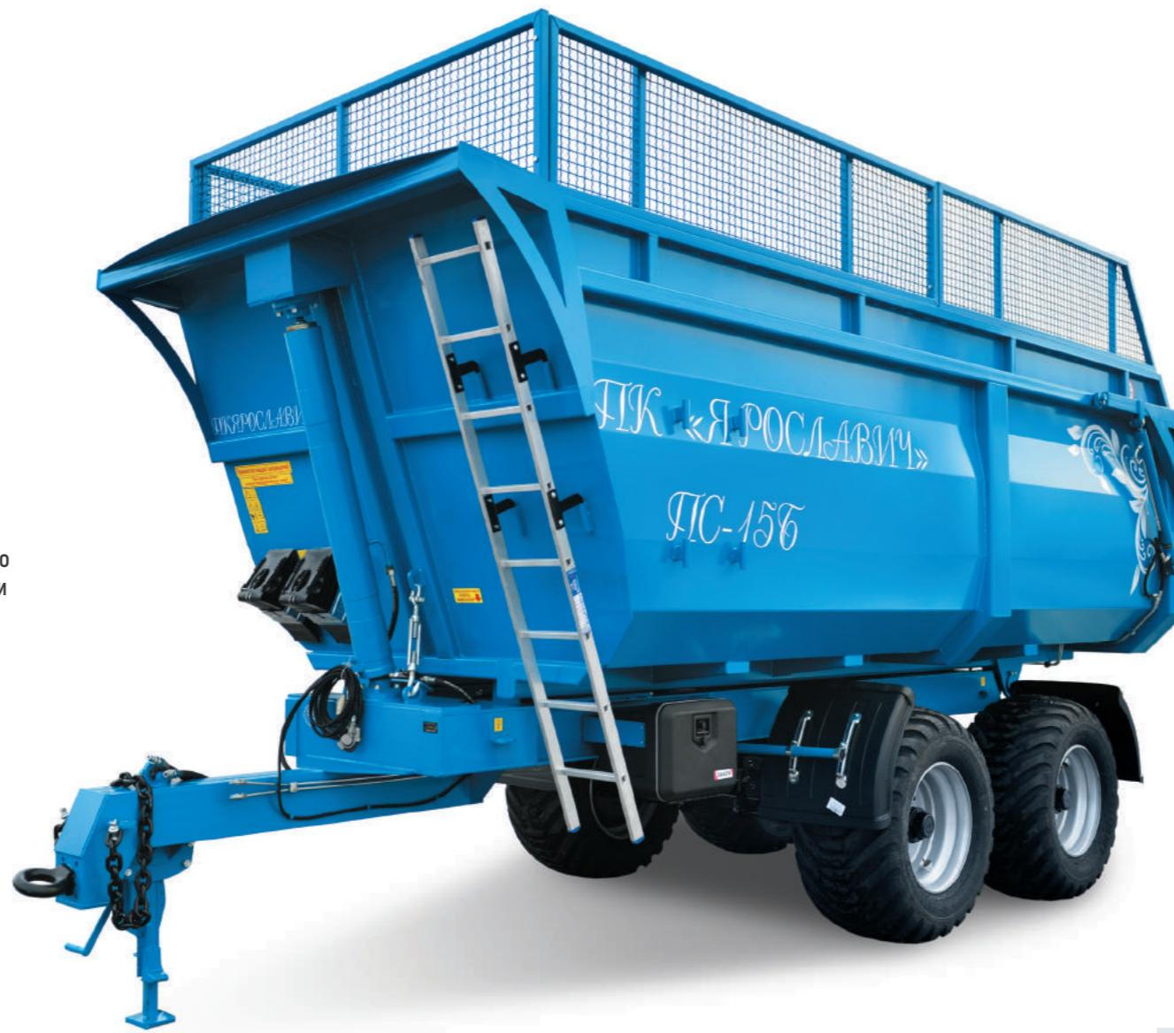
Полуприцеп ПС-15БМ предназначен для перевозки сыпучих и твердых грузов (зерно, корнеплоды, зеленая масса, силос, сенаж, навоз, торф, песок, гравий, удобрения, опилки, снег и пр.) по всем видам дорог и в полевых условиях.
