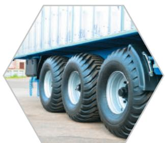
3-х-осная рессорная тележка итальянского производства с подруливающими передней и задней осями и широкопрофильными шинами низкого давления
