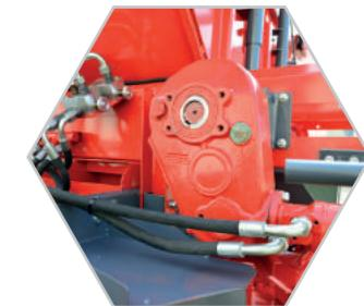
Высокопрочный необслуживаемый подшипниковый узел
