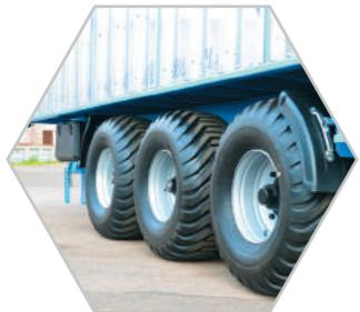
3-х-осная рессорная тележка итальянского производства с подрессоривающей задней осью и широкопрофильными шинами низкого давления
