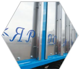
Борта из нержавеющей или оцинкованной стали толщиной 3 мм
