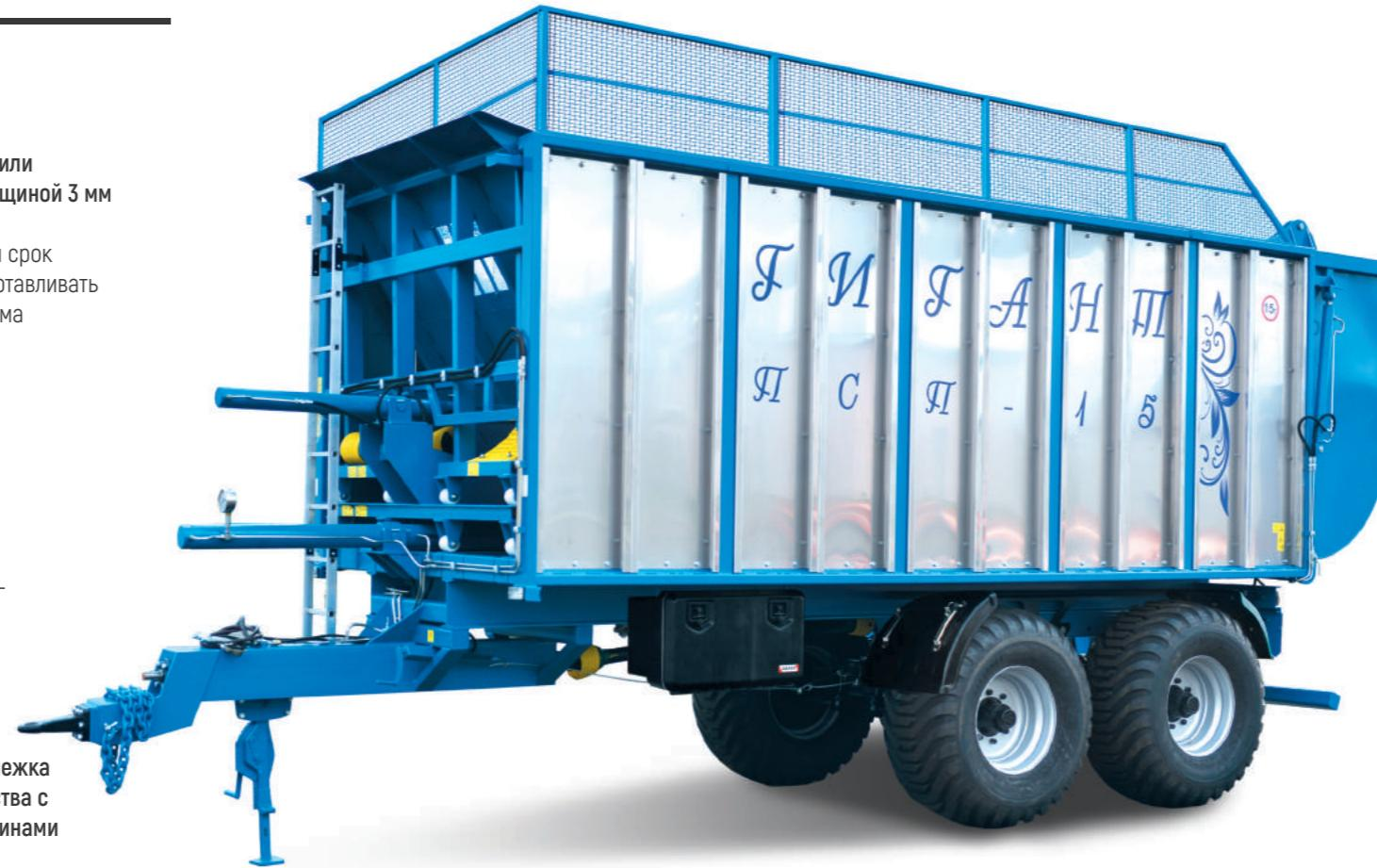
Полуприцеп ПСП-15 «Гигант» предназначен для перевозки различных сыпучих и твердых грузов (зерно, корнеплоды, зеленая масса, силос, сенаж, навоз, торф, удобрения, опилки, снег и пр.) по всем видам дорог и в полевых условиях.
