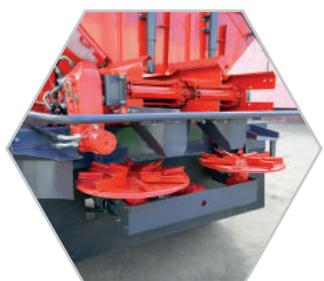
Разбрасывающий механизм, состоящий из 2-х тарелок и цепочно-планчатых транспортеров
