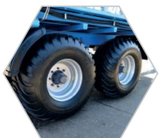
2-х-осная рессорная тележка итальянского производства с широкопрофильными шинами низкого давления
