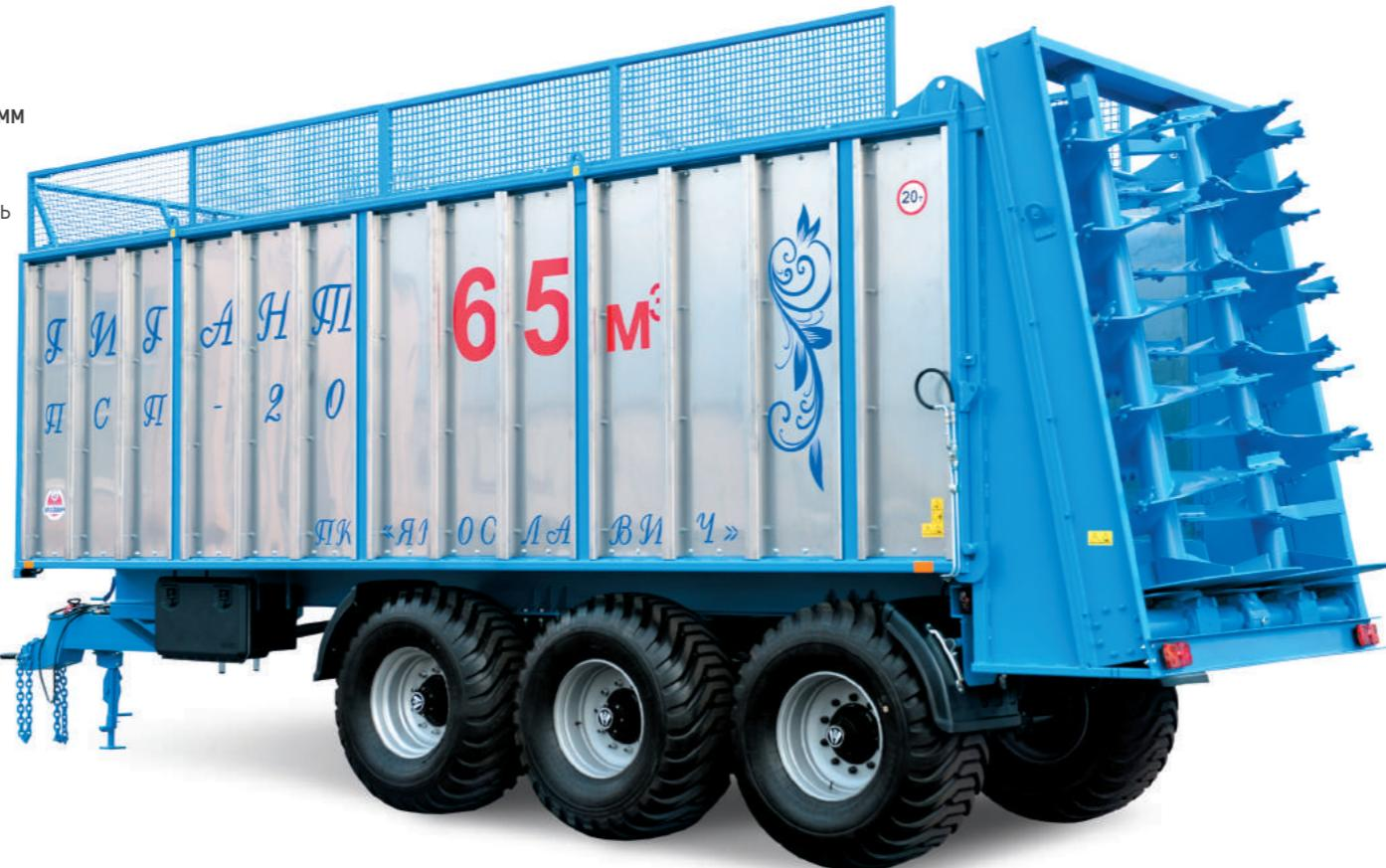
Полуприцеп ПСП-20 «Гигант» предназначен для перевозки различных сыпучих и твердых грузов (зерно, корнеплоды, зеленая масса, силос, сенаж, навоз, торф, удобрения, опилки, снег и пр.) по всем видам дорог и в полевых условиях.
