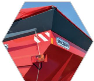
Бункер из конструкционной легированной стали толщиной 3 мм
