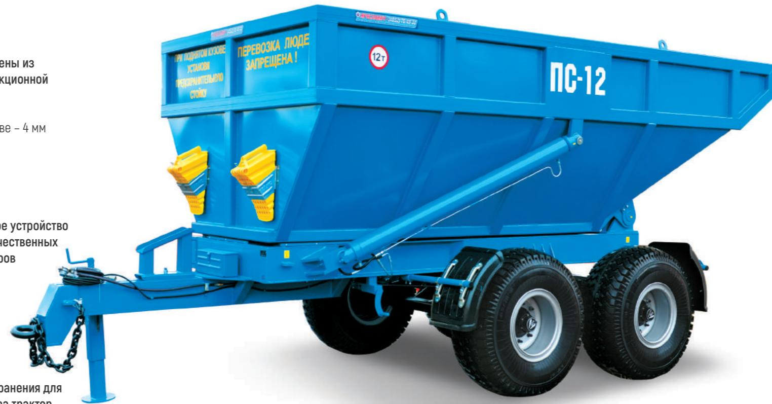
Цельнометаллический герметичный кузов позволяет перевозить полужидкие грузы
